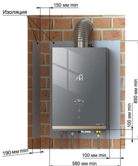
Рисунок 2. Установка аппарата на трудногораемых стенах
